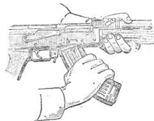
Рисунок 9. Присоединение магазина к автомату
